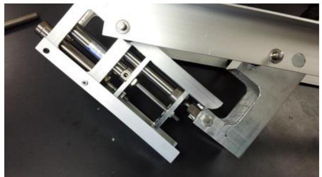
図10：エアーシリンダーを用いた機構
