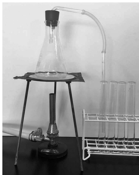
図1 水蒸気蒸留装置
