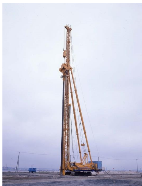
写真-1.2 現在の陸上 SCP 施工機 2)
