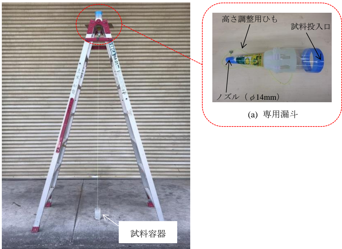
図-5.3 空中法による供試体作製状況
