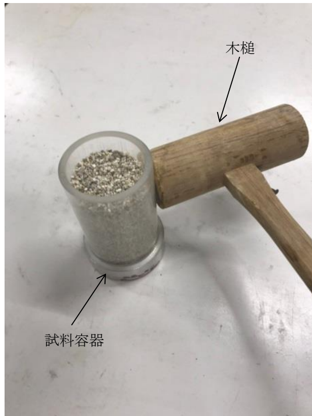
写真-5.2 打撃法による供試体作製状況
