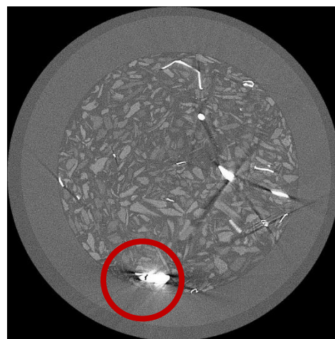
図-4.14 リングアーチファクトの例
