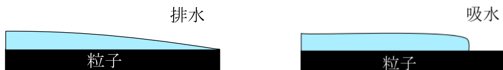
(c) 土粒子表面における排水過程と吸水過程の接触角の違い
