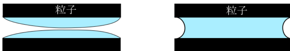
(b) 間隙内部における水膜の接触の違い
