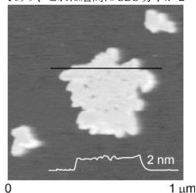
Fig.2  $\text{BaTiO}_3$  ナノシートの AFM 像
