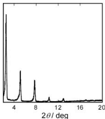
Fig.1 SDS を含む  $\text{BaTiO}_3$  の XRD パターン
