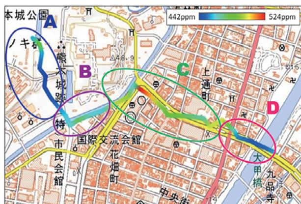
図 6 簡易測定器を用いた熊本市内市街地の大気中二酸化炭素濃度移動測定の結果 [19]。
