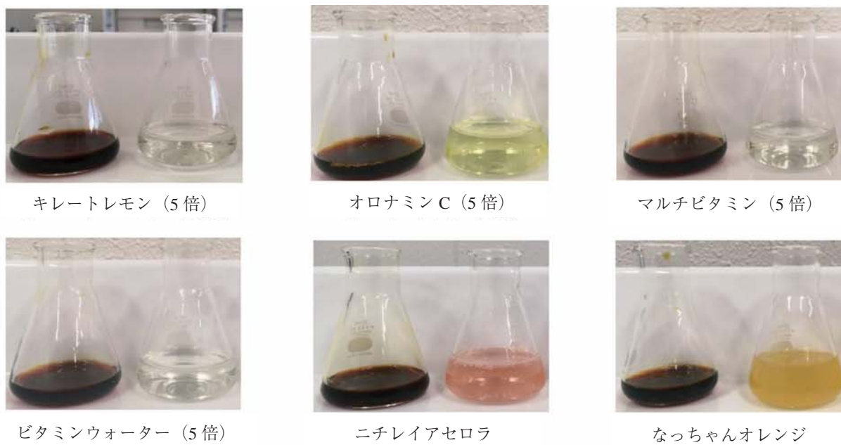
図1 ビュレットを用いて滴定したときの各種飲料水の色調
