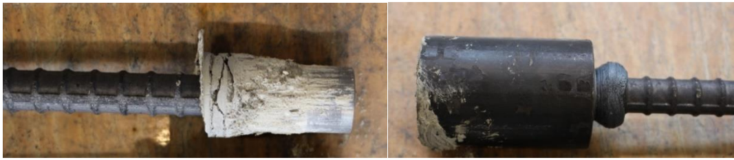
写真 4.6.1 引抜き破壊状況
