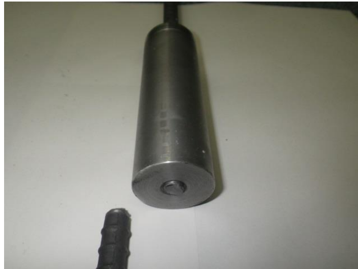
写真 4.2.4 ねじ切り部の破断状況
