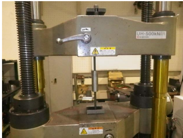
写真 4.2.3 一軸引張試験状況
