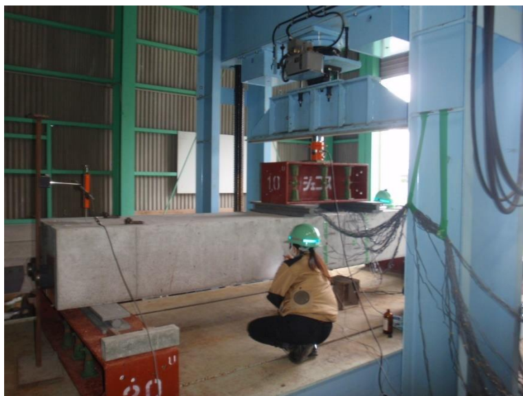
写真 6.4.7 載荷試験状況
