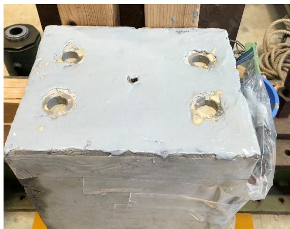
写真 5.2.1 スリーブ側の供試体の接合前状況
