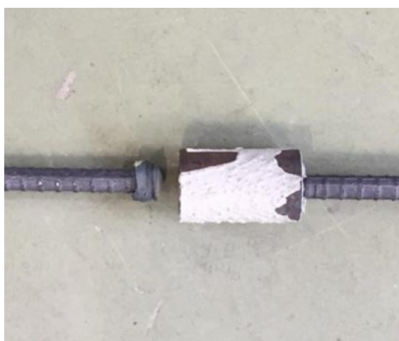
(b) 摩擦圧接部の破断状況（側面）
