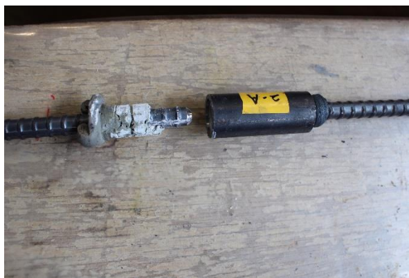
写真 4.4.2 スリーブ部の抜出し状況
