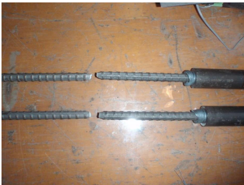
写真 4.2.6 母材鉄筋の破断状況
