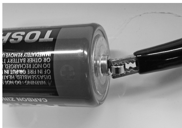
図4 ネオジム磁石を用いた接続
