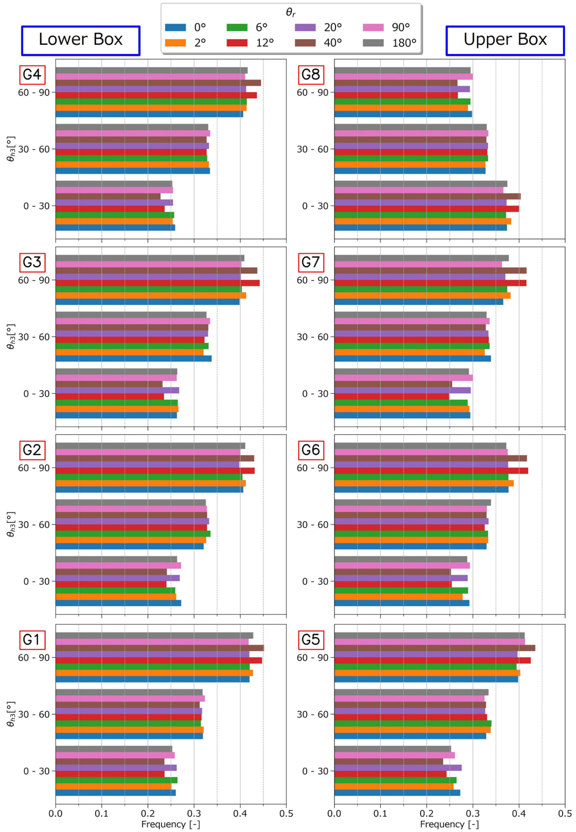
図 7-41 水平断面における粒子短軸の方向とせん断の方向の成す角度 \theta_{h3} (Case4) (使用材料：IW5 が 90%, IW3 が 10%, 供試体作成方法：自由落下法の後、攪拌)
